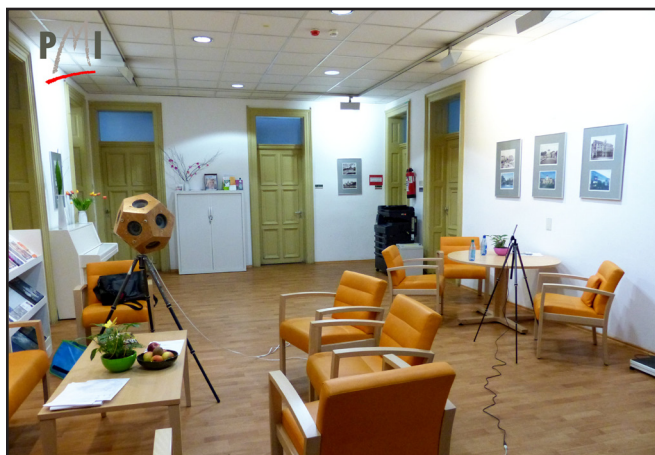
Abb. 7: Messung der Raumakustik, Foyer
